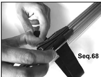
Instalar el alimentador en el perfil inferior con abertura inferior y el Velcro® alrededor del perfil.
