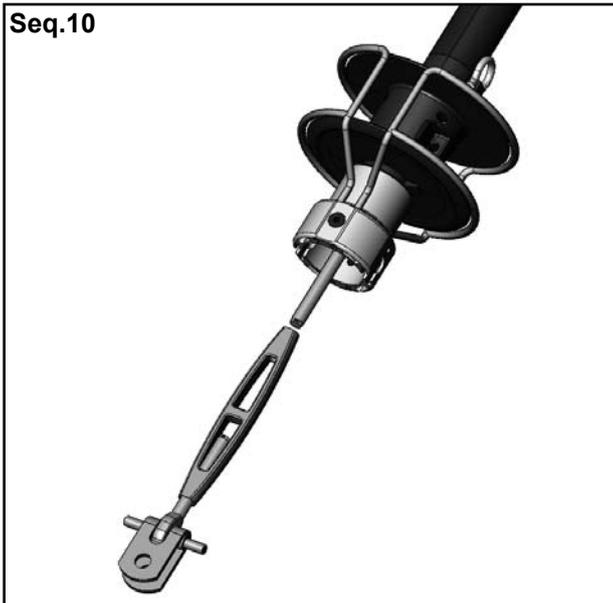
Pase el stay a través de los perfiles. Ponga el terminal tensor con toggle doble sobre el bulón roscado
